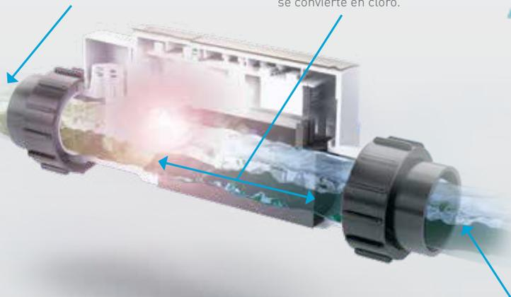
La cloración salina es un proceso por el cual se añade sal común (cloruro sódico) al agua de la piscina y mediante el clorinador de sal, se separa el cloro del sodio. El cloro desinfecta el agua y vuelve a combinarse con el sodio creando sal otra vez y así se repite el ciclo.
