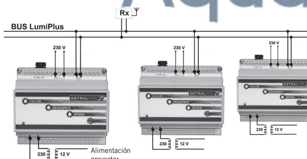
El número máximo de moduladores que se pueden sincronizar es 10, y el número máximo de antenas que podemos colocar en una misma instalación para tener el máximo de cobertura será de 3 antenas.
